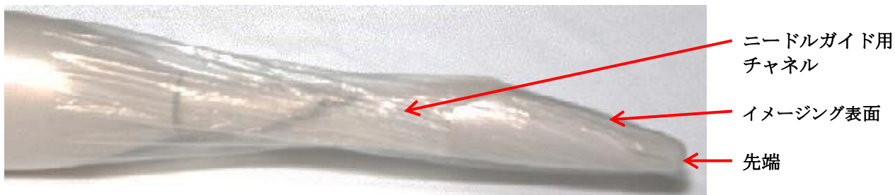
図12 : EV29L™経直腸用リニア型マイクロ超音波トランスデューサとゲル充填済みシース
